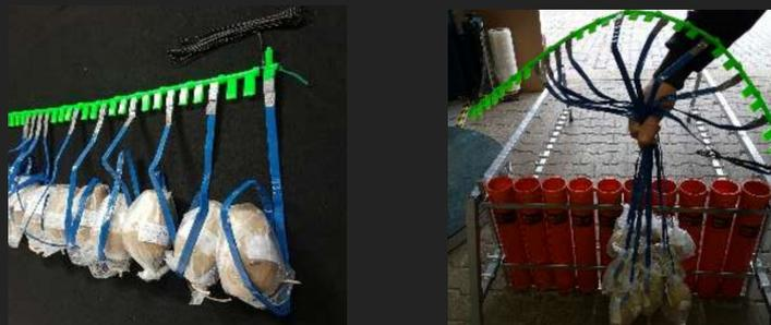
⑤ Nachdem alle Effekte am Easy Way Strang verleitet wurden, kann dieser für den Transport verpackt, oder am Abbrennplatz in die Mörser verladen werden. Der Plastikstrang ist dabei relativ flexibel.
