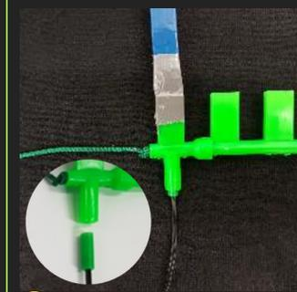
④ Für eine elektrische Zündung können Sie nun am Zündkonnektor einen passenden E-Anzünder (mit 6mm Plastikhülse) in die vorgesehene Aufnahme einschieben. Pressen Sie den E-Anzünder dabei bis auf Anschlag ein. Die Aufnahme ist konisch und dient als Arretierung.
