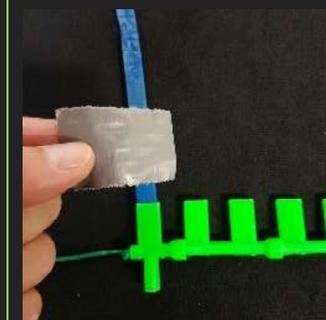
② Zum Fixieren der Stoppine im Konnektor verwenden Sie ein passendes Stück Panzertape oder ähnlich, hochwertiges Klebeband. Bitte beachten Sie, dass die Stoppine auf Anschlag eingeschoben ist.
