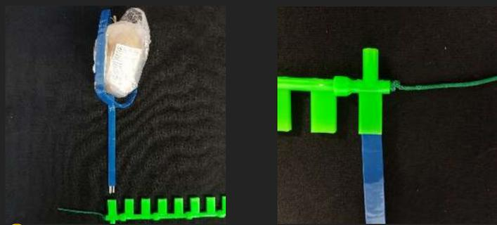
① Stecken Sie die Stoppine der ersten Bombe in die Aufnahme des Zündkonnektors. Bitte beachten Sie, dass die Stoppine ca. 1cm vom Papier freiliegen muss um eine zuverlässige Anzündung zu garantieren.
